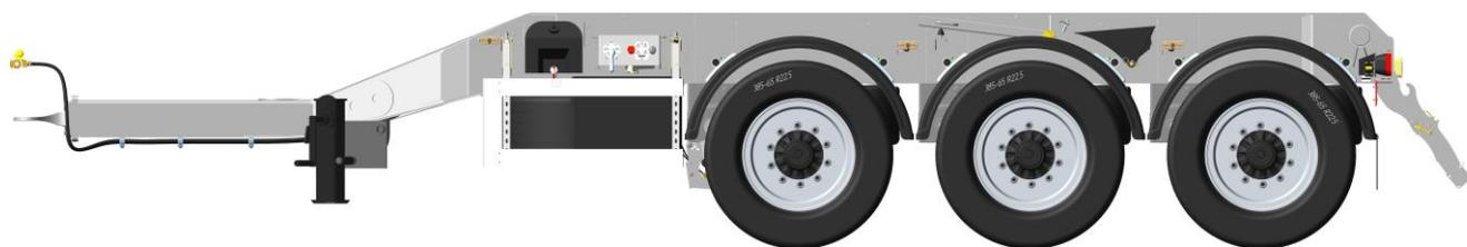
Рис. 11. в) Шасси трехосного прицепа без поворотного круга
