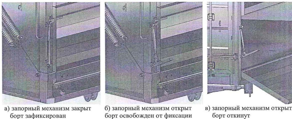
Рис. 26. Запорный механизм боковых бортов платформы.
