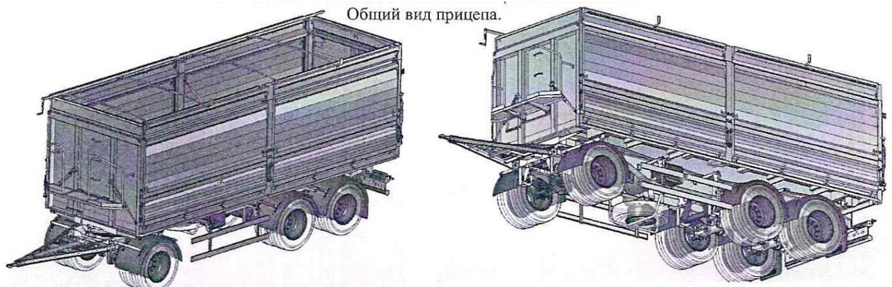
Рис. 1.2 Прицеп самосвальный трехосный с механическим запорным механизмом 7200
