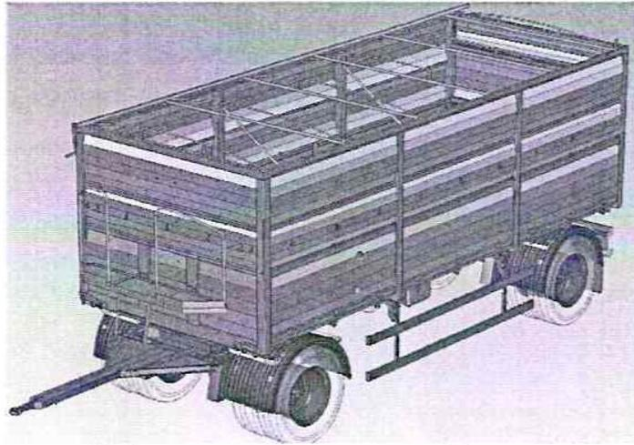
Рис. 1.5 Прицеп бортовой (зерновоз) двухосный с механическим запорным механизмом 6200
